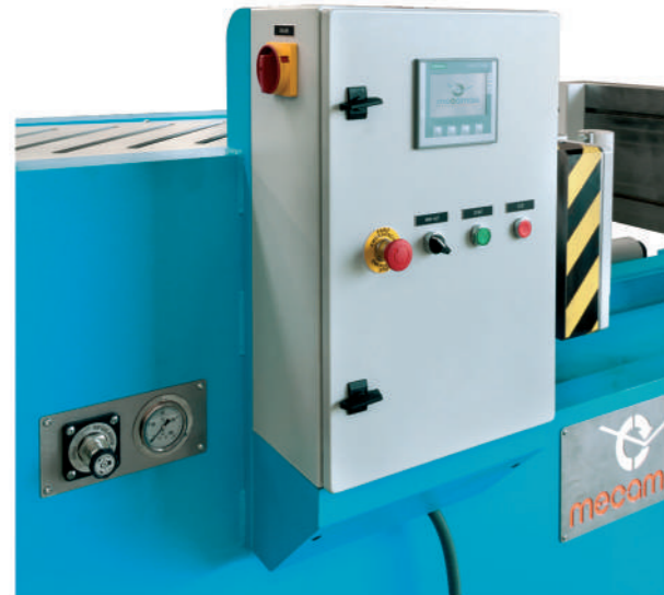
PLC control with tactile panel Control mediante PLC y pantalla táctil
